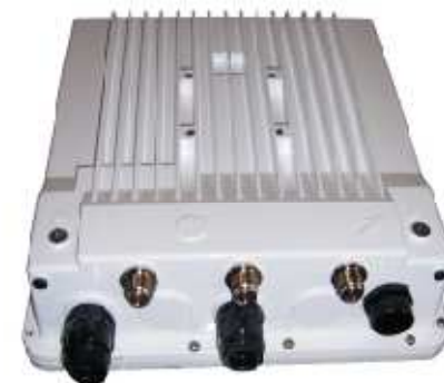
Базовая станция Tsunami MP-8160 с разъемами N-типа
