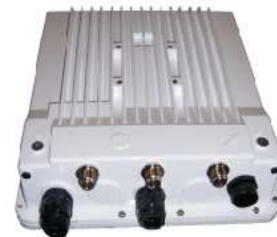
Базовая станция Tsunami MP-8100 с разъемами N-типа
